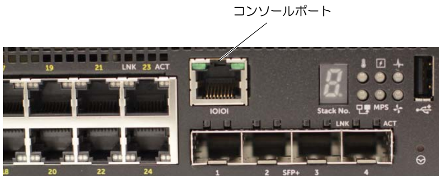
図 1-9. N1524P コンソールポート付きの 前面パネル
